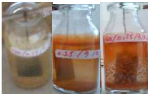
Gambar 6. Foto visualisasi untuk baja lunak dalam 0.25 M H_2SO_4 dengan variasi perendaman 1, 5 dan 9 hari: a) tanpa KMK (atas) dan dengan KMK (bawah)
