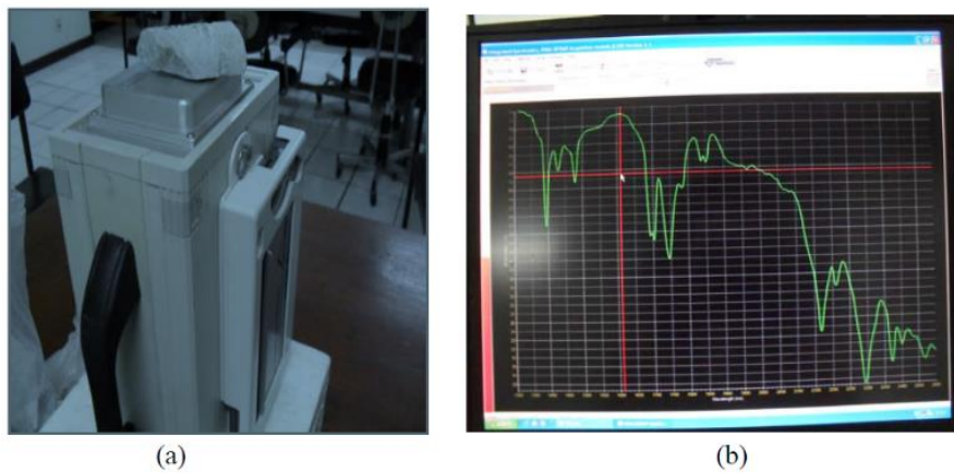
Gambar 1. Pengumpulan data mineral dengan PIMA (a) Sampel serpihan batuan ditempatkan pada lensa spektrometer terintegrasi, dan (b) pengumpulan data dilakukan menggunakan perangkat lunak spektrometer terintegrasi, modul akuisisi PIMA SP/RAP.
