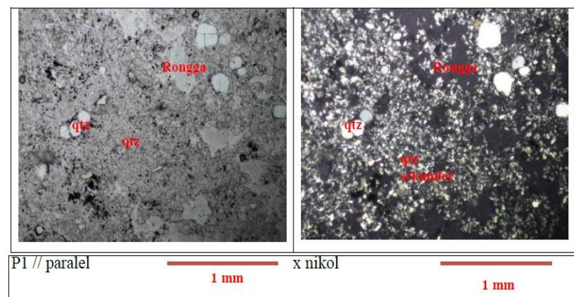
**Gambar 8.** Pada kedalaman 319,85 m sayatan tipis memperlihatkan massa dasar yang tersilifikasi pada batuan asal tuf. (qtz: kuarsa).
