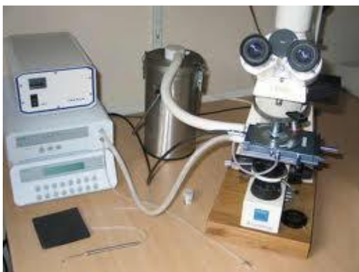
Gambar 2. Perangkat pengamatan inklusi fluida pada saat pengukuran T_h dan T_m .
