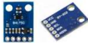
Gambar 2. Bentuk fisik sensor cahaya BH1750 [4]
