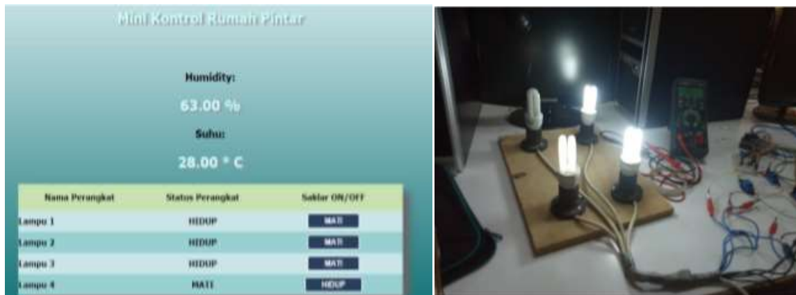
Gambar 5. Tampilan browser dan rangkaian kondisi tiga saklar kondisi hidup
