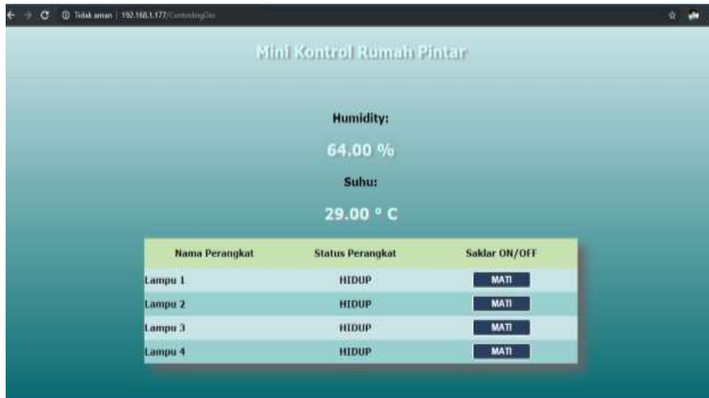
Gambar 2. Tampilan browser menggunakan shield ethernet Arduino
