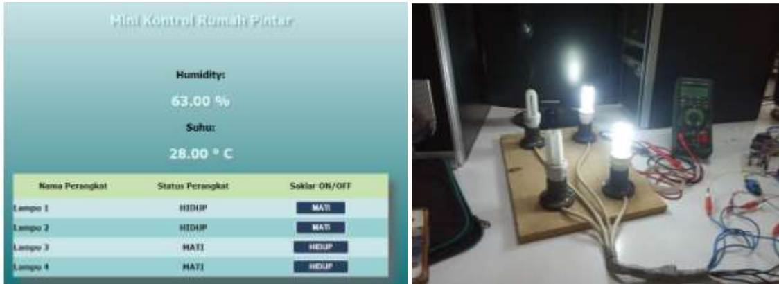
Gambar 4. Tampilan browser dan rangkaian kondisi dua saklar kondisi hidup
