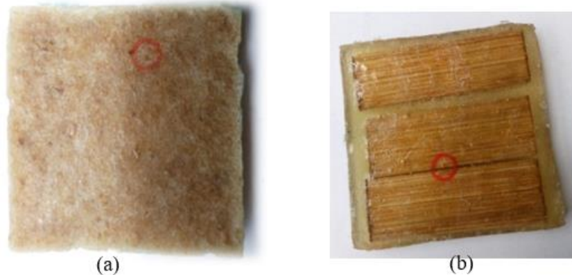
GAMBAR 3. (a) Sampel Komposit Filler Serbuk yang Telah Diuji, (b) Sampel Komposit Filler Memanjang yang Telah Diuji
