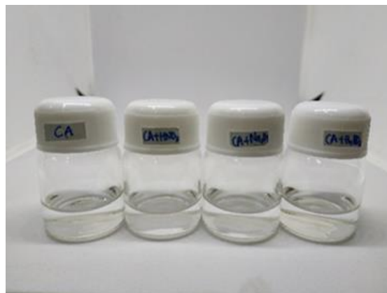
Gambar 3. (Dari kiri ke kanan) Sampel karbon dot asam sitrat murni, doping-N, doping-S, dan doping-B.
