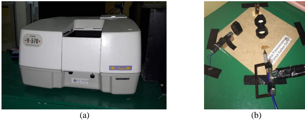
Gambar 4. Alat uji absorbansi UV-Vis (a), dan setup fotoluminesensi (b).
