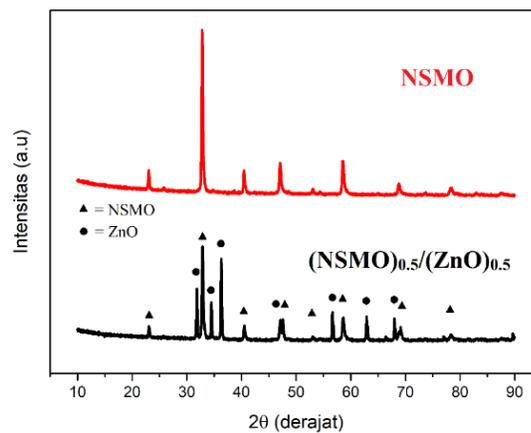
**Gambar 2.** Grafik pola XRD pada material NSMO dan  $(\text{NSMO})_{0.5}/(\text{ZnO})_{0.5}$ .
